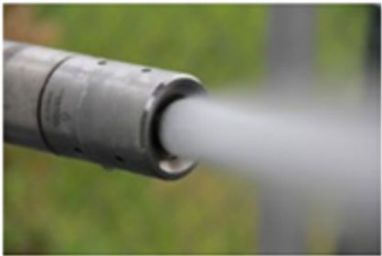
小角度喷枪雾化示意图 Photo of small angle spray lance atomization
