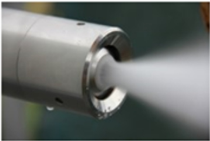
大角度喷枪雾化示意图 Photo of large angle spray lance atomization
